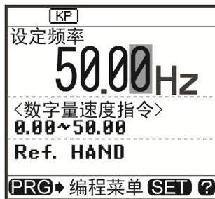
图3.4 频率设定中的显示示例
