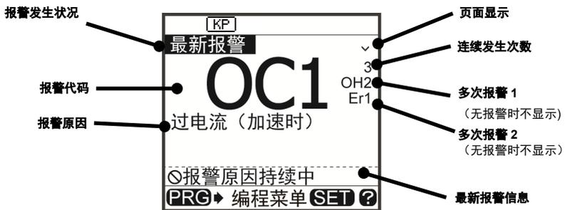
图3.2 各操作模式显示示例
