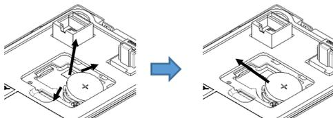
電池左側面2か所の固定ツメを押し広げながら電池を持ち上げます。電池が飛び出さないよう注意してください。
