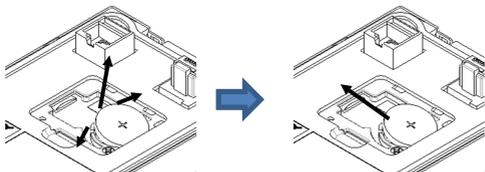
撑开电池左侧2个固定卡扣的同时提起电池
