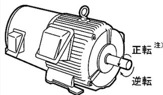
注) IEC 規格に対応したモータの場合、モータの回転方向は上図と反対になります。
