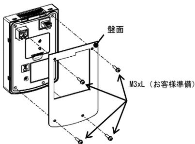
図 2.3(a) キーパッドの取付け
