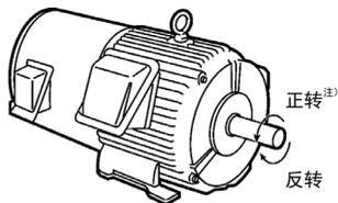
注) 符合 IEC 规格的电机时，电机的旋转方向与上图相反。
