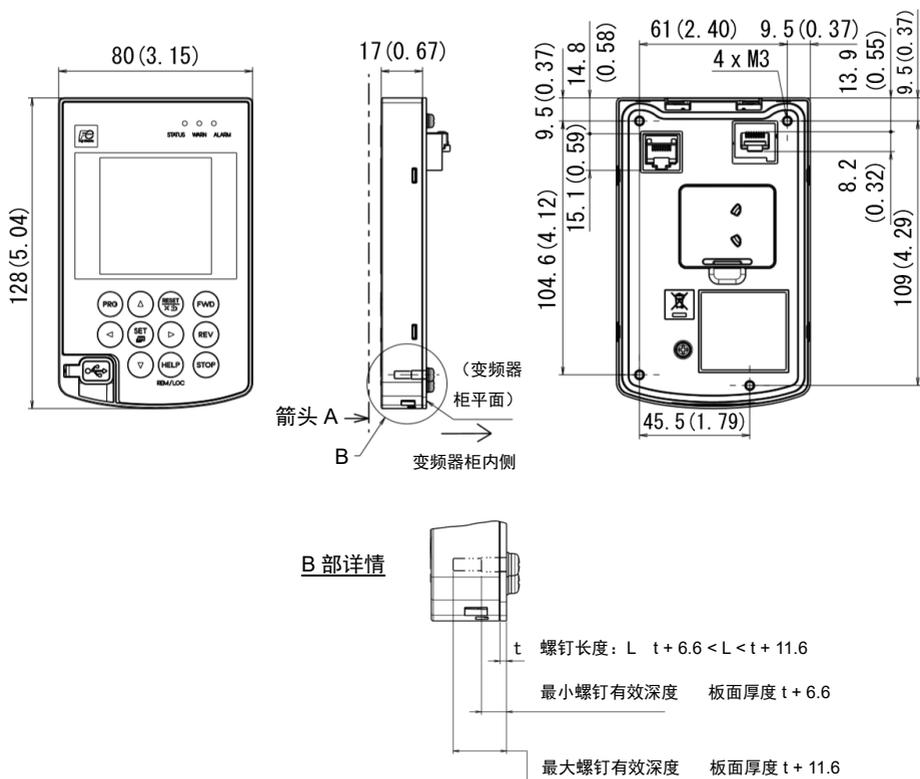
注意: 如果使用超过最大螺钉有效深度的螺钉,可能会损坏操作面板。
