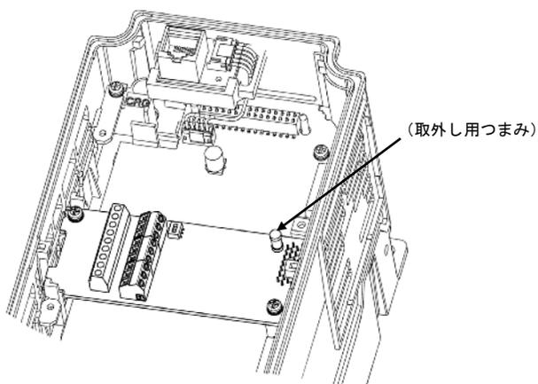
図 1.5 取付け完了（FRENIC-MEGA B-port 取付け時）
