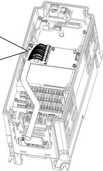
\* インタフェースカードからの配線は、インバータ本体の制御端子台上部と表面カバーの間を通してください。
